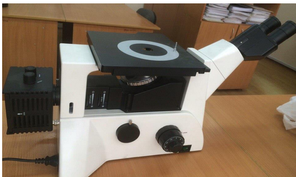
7 Сурет – МЕТАМ ЛВ-34 микроскопының жалпы түрі
