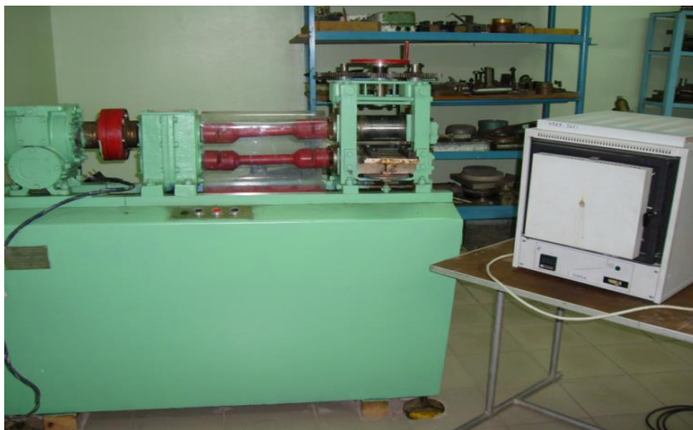
5 Сурет – Жұқарту станы және алдын ала қыздырумен зерттелетін үлгілерді жұқартуды жасауға арналған муфельдік пеш
