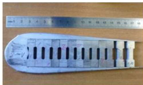
13 Сурет – Пішіні өзгертілген сыналы дайындамадан керуге арналған үлгілерді кесу схемасы
